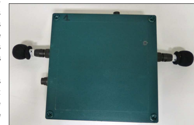
Illustration 1 : Matériel de détection ultrasonore utilisé (SM2 Bat)
