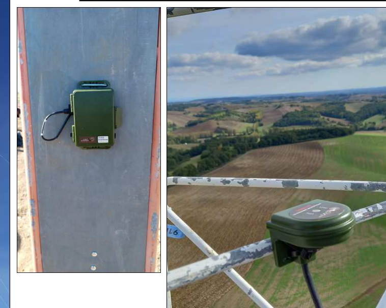
Mât de mesure, boîtier SM4Bat ZC et micro
