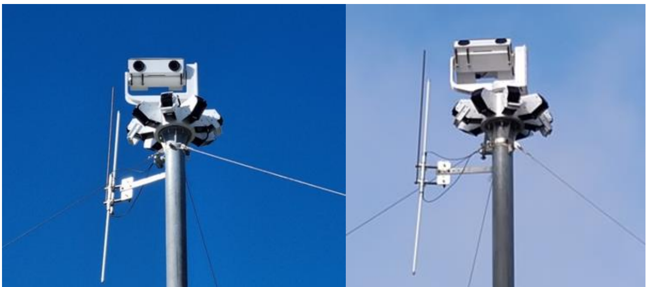
Fig. 1: Le système IdentiFlight (montage sur une tour de 10 m sur le parc) et vue détaillée de la tête d'imagerie avec huit objectifs grand angle disposés à 360° et la caméra stéréo pivotante et orientable.
