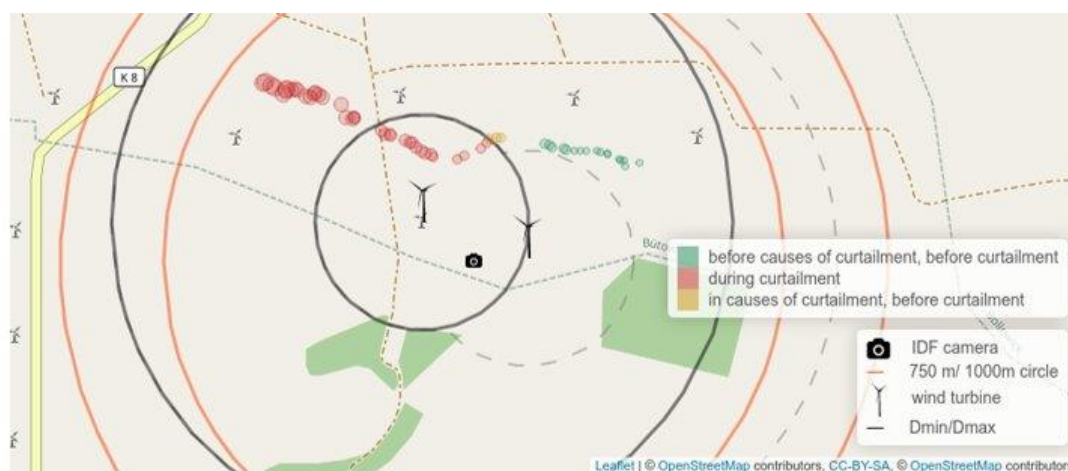
Fig. 6: Exemple de mise en bridage (curtailment) pour un Milan royal entrant par l'est dans le cylindre d'espacement intérieur (points verts : pas de mise en bridage, points rouges : mise en bridage).
