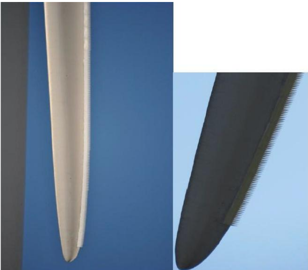
Figure 3. Exemple de serrations mis en place sur les éoliennes (source Vestas)
